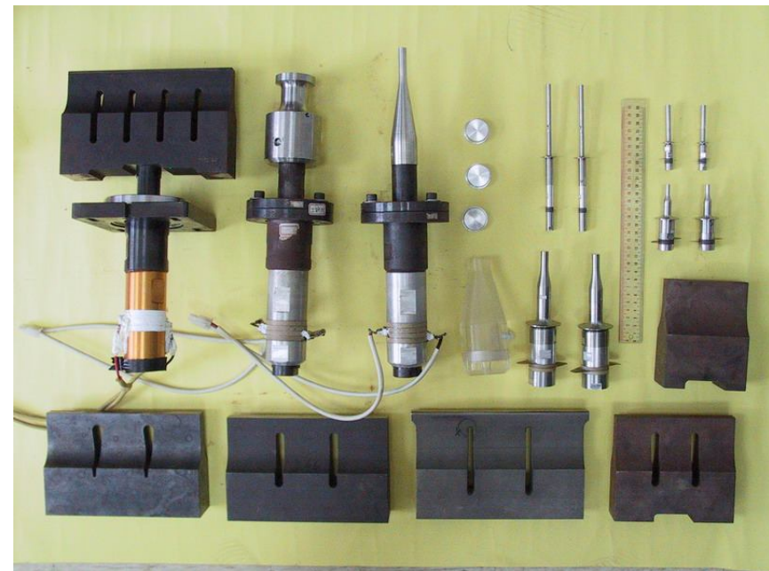
超音波機電轉換及機械放大系統
